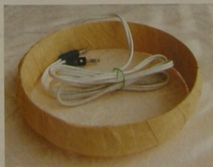
Obr. 5. Konečná podoba aplikační cívky o průměru 16 cm
