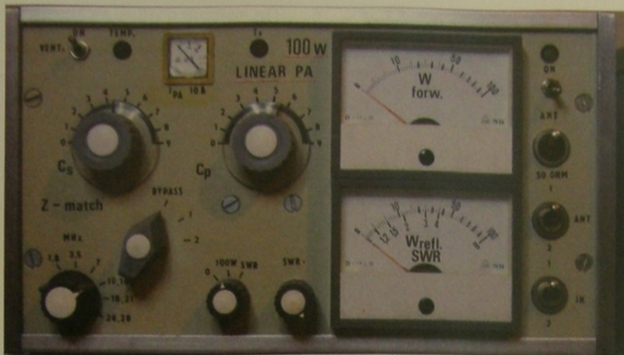
Obr. 2. Lineární koncový zesilovač domácí výroby OK1ZKQ
