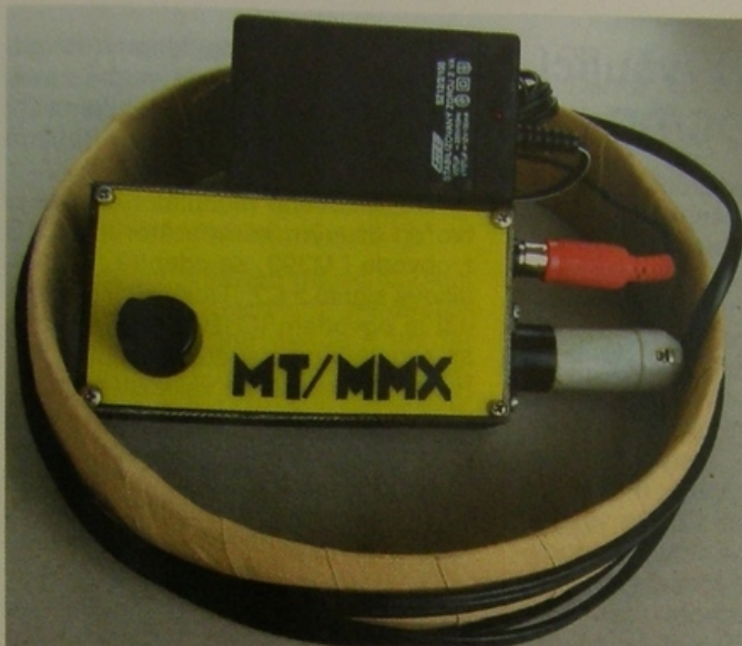
Obr. 3. Pohled na kompletní zařízení pro MT. V aplikační cívice o průměru 16 cm leží upravený síťový adaptér s výstupním napětím 14 V a generátor impulsů MT/MMX
