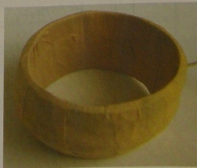
Obr. 7. Aplikační cívka o vnitřním průměru 96 mm
