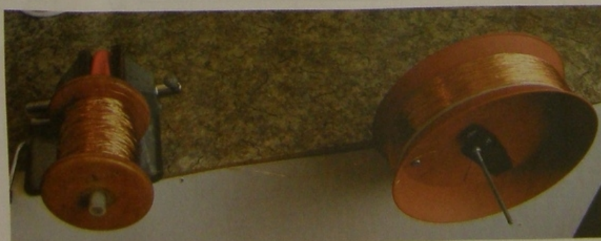
Obr. 4. Přípravek pro navíjení aplikačních cívek
